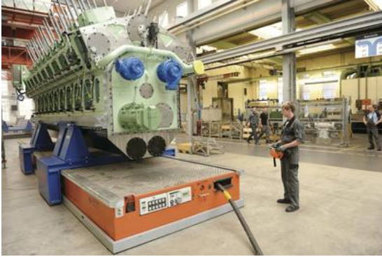
Transport des Motors in mit Hilfe des Luftkissenfahrzeuges.
