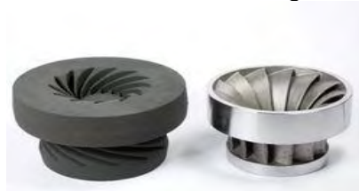
konventionell hergestellter (li.) u. 3D-gedruckter Kern (re.)
